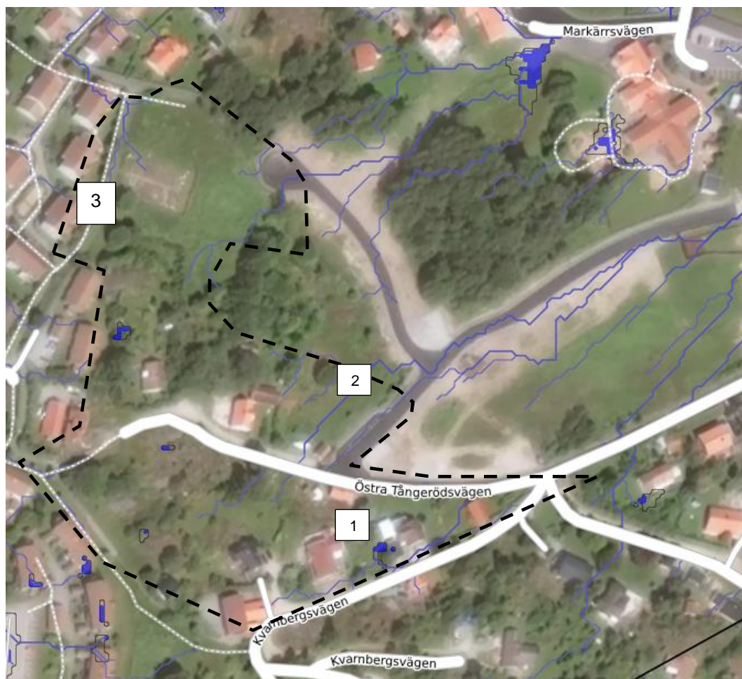
Figur 10. Figuren visar skyfallsstråk med tillrinnande yta på minst 500 m 2 . Lågpunkternas utbredning visas i blått.
